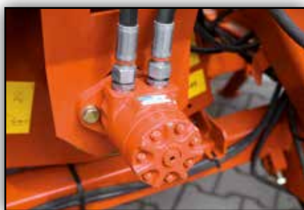
Optional external hydr. fan drive
